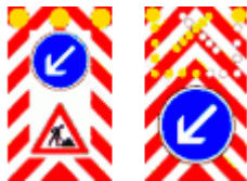
車道封閉板 因道路施工暫時關閉車 道，並指示改道行駛方向
